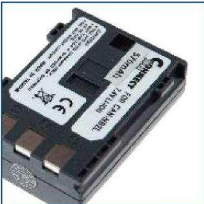
Li-Ion-Akkus besitzen eine hohe Energiedichte, kurze Ladezeiten und ein geringes Gewicht, sind jedoch teurer als Ni-MH-Akkus und benötigen eine spezielle Ladetechnik. Da sie eine höhere Spannung als Ni-MH Akkus besitzen und zudem aus Sicherheitsgründen eine Schutzelektronik benötigen, sind Li-Ion-Akkus nicht als handelsübliche Rundzellen erhältlich. Besonders geeignet sind sie für moderne Hightech-Geräte wie Notebooks, Mobiltelefone, Digitalkameras und Camcorder.
