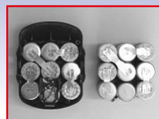
Der neue Akkublock wird in das gebrauchte Gehäuse eingesetzt und die Anschlussbleche werden angelötet.
