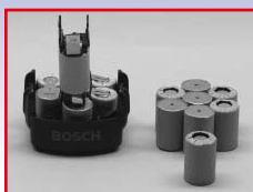
Der Akkublock wird aus einzelnen Zellen genau dem defekten Muster nachgebaut.
